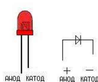
Но не всякий р-n-переход излучает свет. Почему? Во-первых, ширина запрещенной зоны в активной области светодиода должна быть близка к энергии квантов света видимого диапазона. Во-вторых, вероятность излучения при рекомбинации электронно-дырочных пар должна быть высокой, для чего полупроводниковый кристалл должен содержать мало дефектов, из-за которых рекомбинация происходит без излучения. Эти условия в той или иной степени противоречат друг другу.
