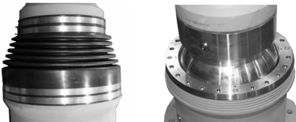
Рис.12 Снимите зажимы и поднимите протектор на упорную трубу.
