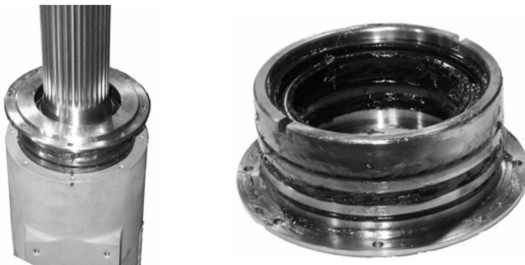
Рис. 15 Снимите крышку (подбору, снимите фиксирующее кольцо, уплотнения, проставыш и уплотнительное кольцо)
