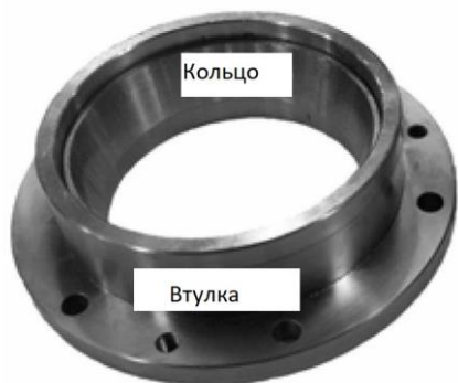
Рис. 24 Извлеките наружное кольцо из втулки подшипника.
