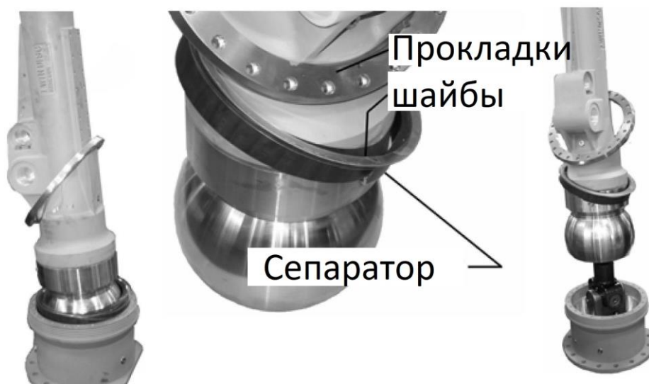
Рис. 14 Снять крышку, шайбы, сепаратор и поднять узел упорного шарнира.
