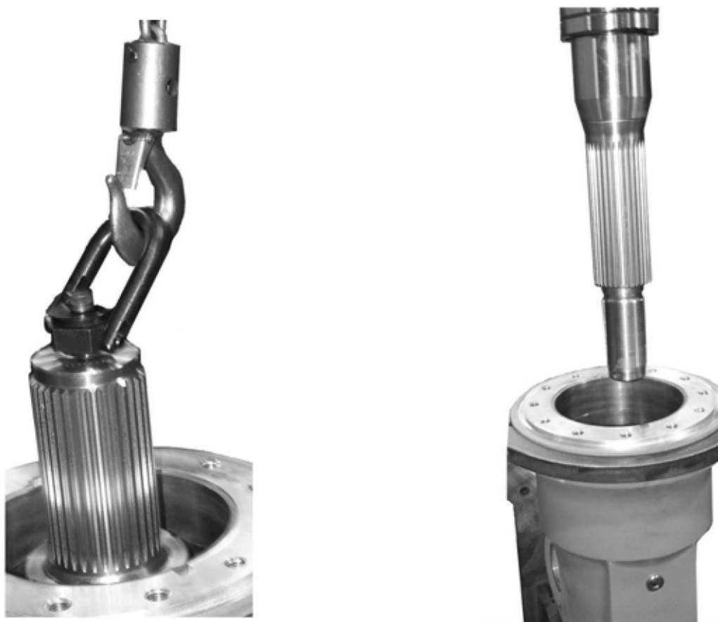
Рис.18 Вставьте рым-болт в вал, поднимите узел вала из упорной трубы.
