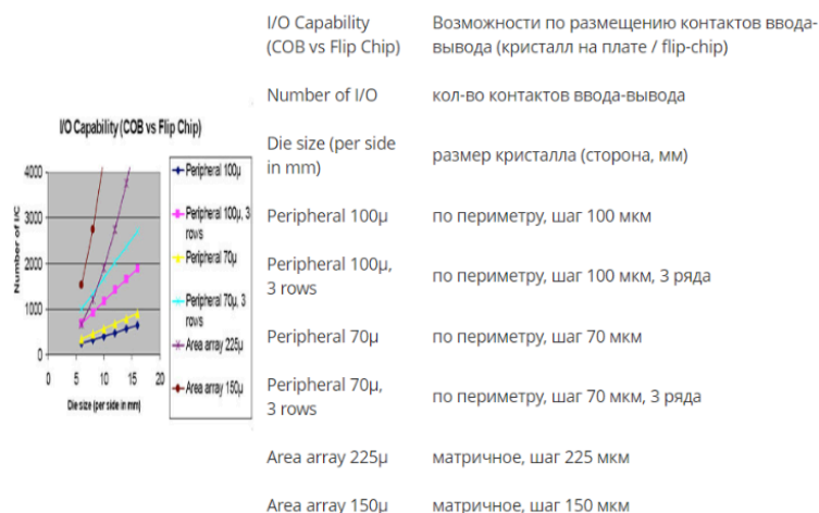
Рисунок 7 - данные по возможному количеству контактов ввода-вывода при применении технологии flip-chip с современным шагом выводов и при размещении контактных площадок по периметру кристалла показывают, что технология flip-chip обладает гораздо большими возможностями по созданию устройств с большим количеством выводов.
