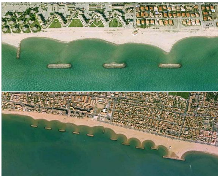
Рисунок 1 – Франция. Формирование бухтовых пляжей естественным потоком наносов под защитой возведенных прерывистых волноломов. Хорошо виден порядок формирования салиентов и томболо
