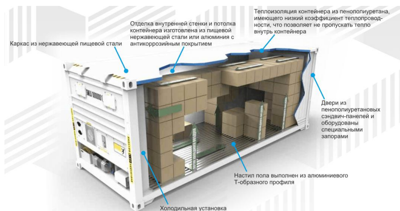
Рисунок 2 - Составные элементы рефрижераторного контейнера [3]
