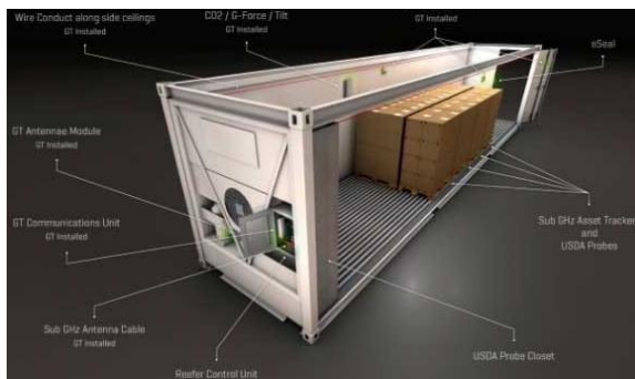
Рисунок 1. Составные элементы умного контейнера Источник: ( https://medium.com/ )[1]
